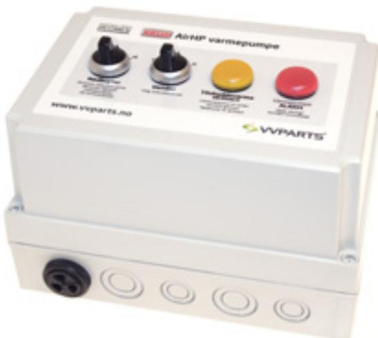
Om man skal benytte luft/vann-varmepumpe i et eksisterende vannbårent anlegg med oljekjel eller annet høytemperaturanlegg, er et godt system for å styre tilskuddsvarmen en betingelse. Vi har derfor utviklet vår egen kontrollboks, som kunden selv kan betjene. Den sørger for å aktivere tilskuddsvarmen dersom varmepumpen skulle få driftsavbrudd, og er utstyrt med nødbryter for manuell tilkobling. Boksen har visuell og akustisk alarm og mulighet for tilkobling til GSM-sender eller boligalarm.
